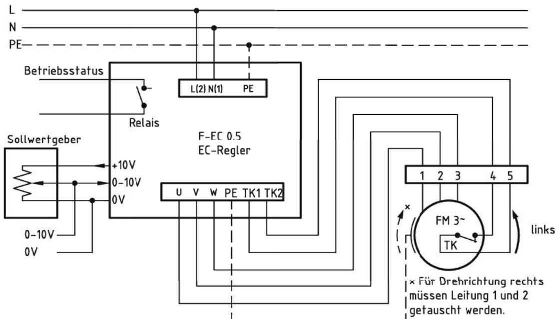
\* Das Anschließen der Geräte erfolgt nur nach den beigegeführten Technischen Unterlagen
